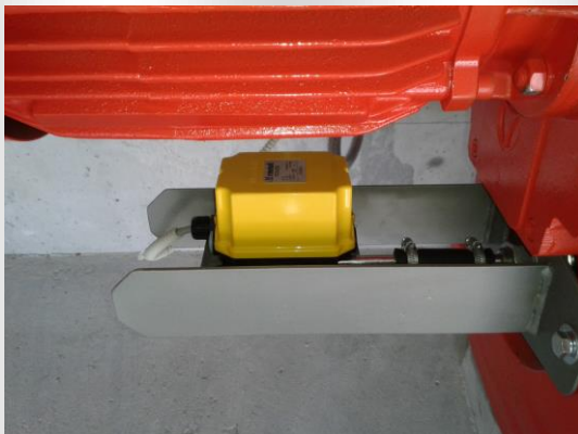
Števec obratov, ki omogoča nastavitve zgornje in spodnje končne lege ter vmesne lege.
